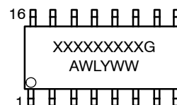
SOIC-16 D SUFFIX CASE 751B
